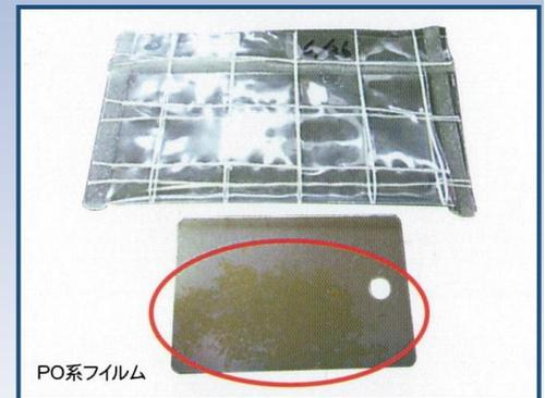
プライクリーンPZ-500には気化性防錆剤が含まれていて、常温で徐々に昇華(気化)して大気中の水蒸気に溶解します。水蒸気中に溶け込んだ防錆成分によって、鉄系金属表面にできる不均等電位を抑え、電気化学反応を抑制して防錆します。
