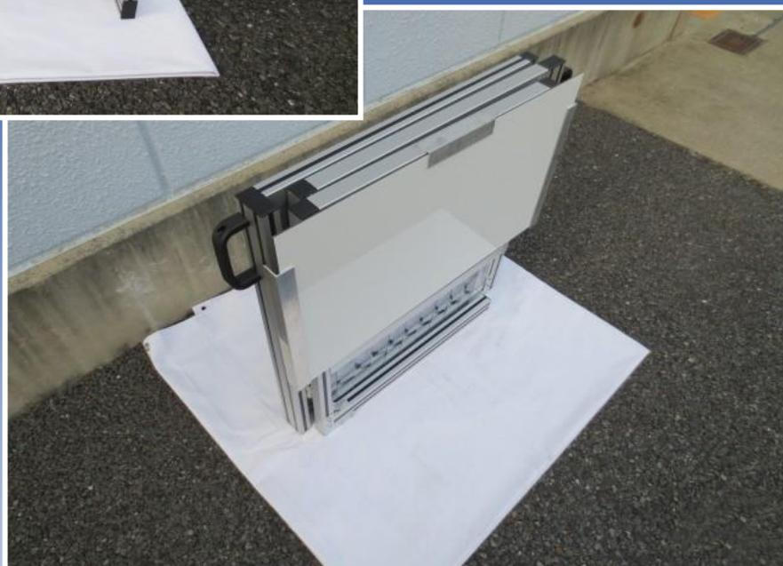
高速切断機でアルミフレームや鉄骨などを切断する時、切り屑が周りに飛び散ります。後片付けの掃除に時間が掛かったり、火花が飛んだりして火災の原因にもなります。今回、アルミフレームを使った折り畳み式飛散防止カバーを製作しました。側面と上面にはスチールパネル、側面下部にはのれん状の塩ビ防災シートで飛び散りを防ぎます。折り畳み式にしたので、現場などに持ち運ぶことができるのでお客様に迷惑がかりません。
